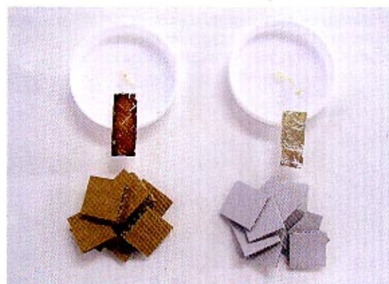
▲比較実験結果。密閉ガラスびんにそれぞれ普通の段ボール(左)とアーカイバルボード(右)を入れ、銀箔をつるして4か月放置。左は酸化水素により変色した銀箔、右は変化のない銀箔。
